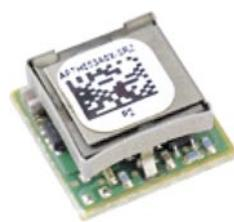
Габариты преобразователей типа ARTH003A0X —  $12,2 \times 12,2 \times 6,25$  мм, преобразователей типа ARTH006A0X —  $12,2 \times 12,2 \times 7,25$  мм.
