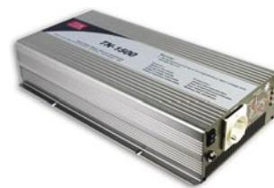
При продолжительной работе инвертор выдает переменное выходное напряжение синусоидальной формы (отклонение не более 3%) мощностью 1500 Вт. Непрерывно, в течение 3 мин. обеспечивается 1725 Вт и в течение 10 с — 2250 Вт. Это мощный инвертор со встроенным зарядным устройством,
