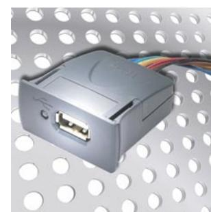
Два из них, VDRIVE2 и VMUSIC2, будут поставляться в законченном конструктиве, подходящем для монтажа в готовые изделия. Для связи с прибором может использоваться интерфейс SPI или UART, выбор которого осуществляется с помощью джамперов.
