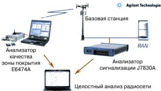
Данные, полученные с помощью Agilent E6474A Drive Test (для анализа качества зоны покрытия), импортируются в анализатор сигнализации Agilent J7830A для протокольной трассировки данных, полученных по радиоинтерфейсу. Анализатор работает как с технологией UMTS, так и с cdma2000.
